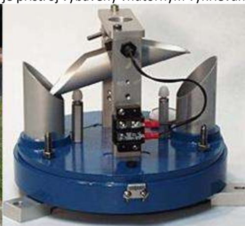
Člnkový zrážkometer so zobrazením vnútorného usporiadania preklápacieho člňa
