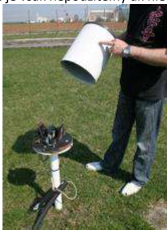
Člnkový zrážkometer so zobrazením vnútorného usporiadania preklápacieho člňa
